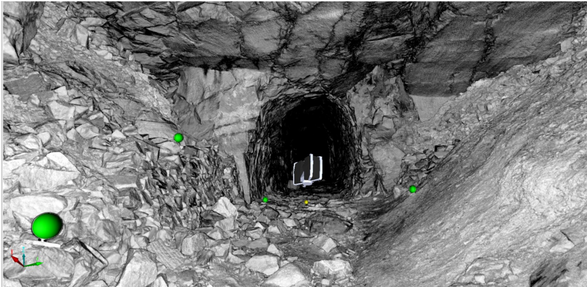
Εικόνα 4: Τρισδιάστατη απεικόνιση (ασπρόμαυρη) μέσα από τη στοά, μέσω του 3D σαρωτή. Διακρίνονται οι θέσεις των σφαιρών στόχευσης.
