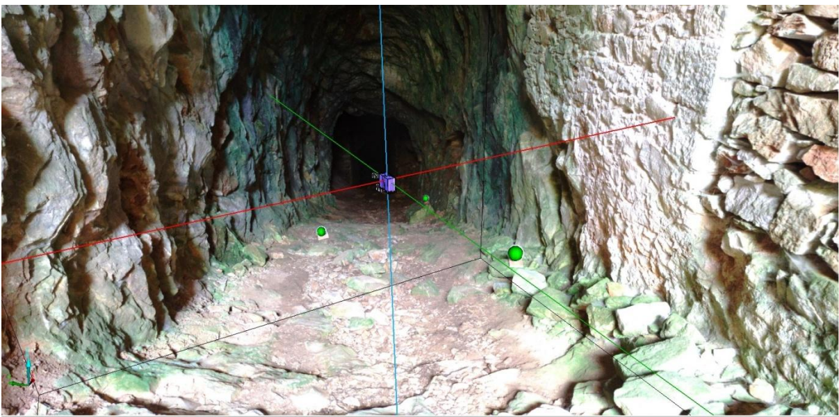
Εικόνα 5: Εγκατάσταση του 3D σαρωτή και των σφαιρών στόχευσης κατά μήκος της στοάς
