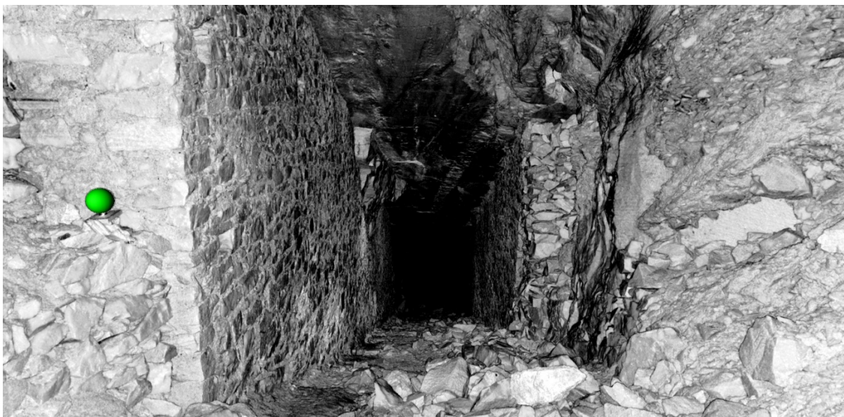
Εικόνα 9Α: Τρισδιάστατη αποτύπωση της στοάς μέσα από το λογισμικό Faro Scene (2)
