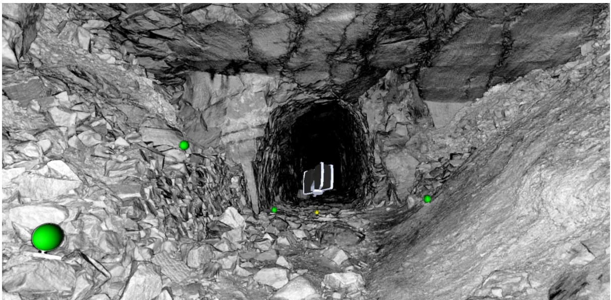
Εικόνα 8Α: Τρισδιάστατη αποτύπωση της στοάς μέσα από το λογισμικό Faro Scene
